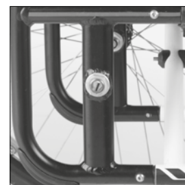
MA 114 Mozzo ruote posteriori fisso, saldato
