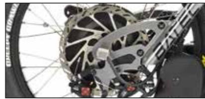
Un motore brushless da 250 giri/min ad alta potenza. Potenza nominale: 900W. Potenza di picco: 1050 W.
