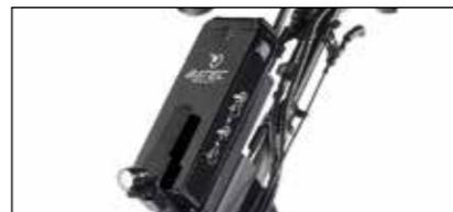
Autonomia: 27-40 km\* con batteria da 280 Wh. 50-75 km\* con batteria da 522 Wh.
